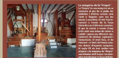
La "limpia" és una màquina on se separava el gra de la palla, les pedretes i d'altres cereals com la veza (algarrobia) o pessolins. El seu funcionament a través de la força hidràulica es componia de diferents mecanismes de tamizado, aspiración i humectación. El molí Nou, el de Palomiet i el Molí del Pontaró estaven dotats d'aquesta màquina. Al segle XX els tres molins van adaptar a la tecnologia de "limpia" una dinamo amb la que s'aconseguia transformar la força hidràulica en elèctrica per als molins.
